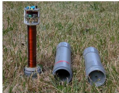
La balise d'émission (à gauche) sortie de son tube de protection (au centre) et le boîtier d'alimentation 24 volts (à droite)
